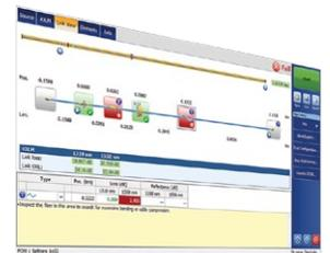
iOLMが、必要に応じてショート/ミディアム/ロングパルスを組み合わせ、テスト対象のあらゆるリンクのテストパラメータを動的に調整します。
