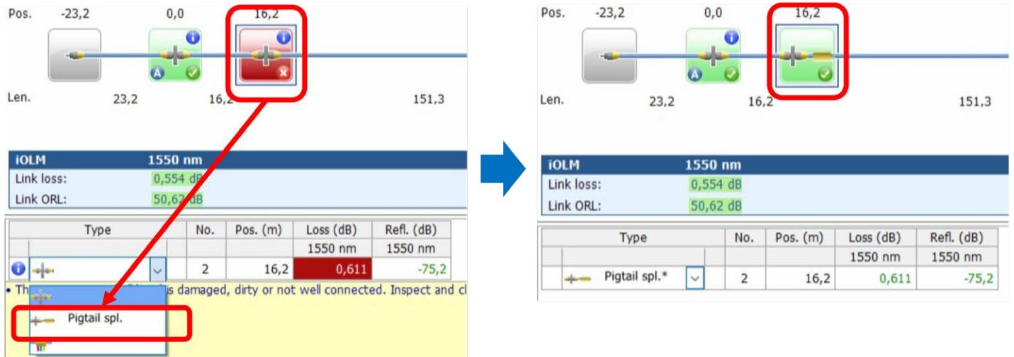
Quando si cambiano gli eventi da un connettore normale (soglia a 0,5 db nell'esempio precedente) a un "connettore giuntato a coda di rondine" personalizzato, appare un'icona personalizzata e l'unità si regola su una soglia personalizzata (0,75 db nell'esempio precedente), in modo da evitare falsi guasti. Gli elementi modificati sono contrassegnati da un asterisco (\*) per poter essere tracciabili.
