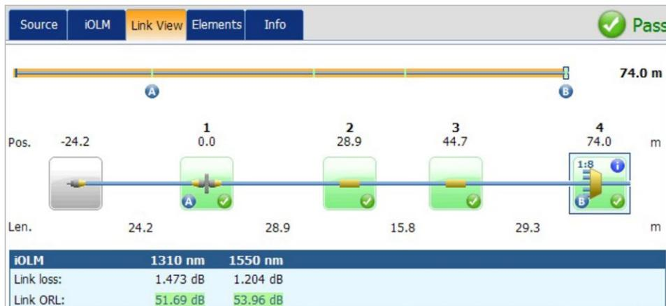
Figura 3. Test superato: la perdita nell'ultimo miglio e l'ORL sono conformi alle specifiche. La presenza dello splitter è confermata, corrisponde al rapporto previsto e c'è continuità con il feeder. L'installazione dell'ultimo miglio è garantita.
