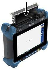
Tournez les deux vis de fixation dans le sens des aiguilles d'une montre pour maintenir le module en place. Sa façade doit être alignée sur le panneau avant de l'appareil.
