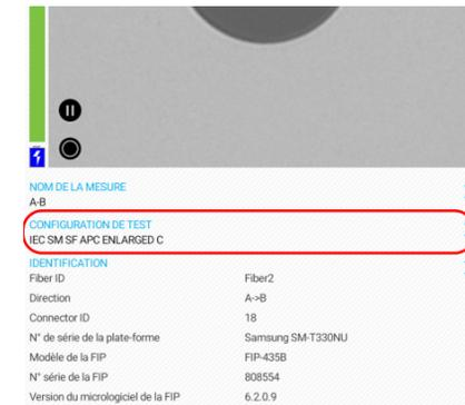
8 En mode Vidéo en direct, appuyez sur la ligne **Configuration de test**.
