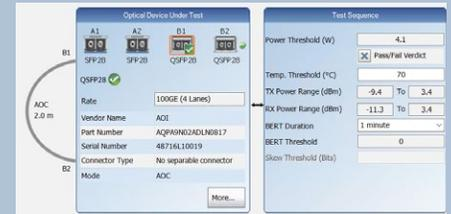
iOptics est une application intelligente de test optique enfichable qui offre un outil complet, puissant et facile à utiliser pour valider n'importe quel type d'émetteur-récepteur 100M à 100G ou de câble AOC. Il s'agit d'un test de première alerte qui peut être utilisé dans votre centre de données pour évaluer efficacement le bon fonctionnement d'un émetteur-récepteur optique avec une configuration utilisateur minimale. La séquence de test automatisée comprend :
