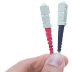
Les cordons de test d'EXFO suivent un code de couleurs, ce qui permet d'éviter les erreurs de manipulation lorsqu'ils sont connectés aux ports et à l'appareil. De plus, les instructions interactives de l'interface utilisateur sont présentées dans le même code de couleurs; le processus s'en trouve donc simplifié.
