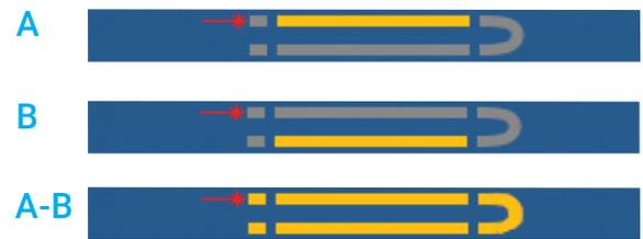
*O uso do método de teste de loopback e a opção do iLOOP no seu iOLM permite que você teste duas fibras de uma só vez. Visualize apenas a ligação A, a ligação B ou a ligação completa A-B, incluindo o loop.*
