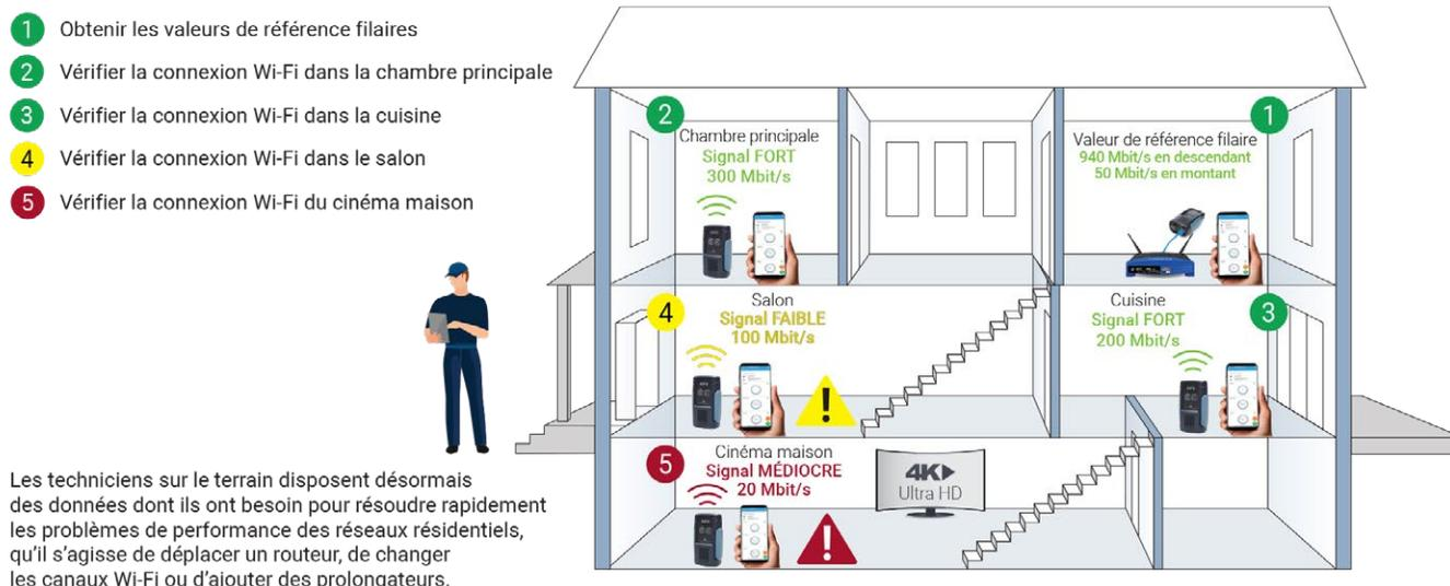
La figure ci-dessus résume les étapes typiques de l'installation d'un service gigabit à large bande résidentiel avec l'EX1.
