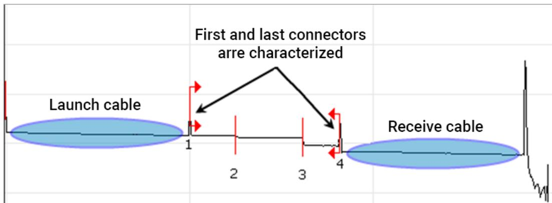
**Note :** Pour mesurer la perte dans le premier connecteur avec le câble de lancement SPSB-EF, la largeur d'impulsion OTDR doit être de 100 ns ou moins et la connexion au port OTDR doit avoir une valeur de réflexion de  $-45$  dB ou mieux. Une liaison de test de 50  $\mu$ m doit également être sélectionnée.
