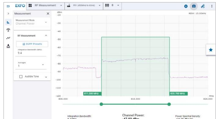
Figure 12. Mesures de puissance des canaux.
