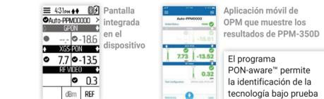
● OPM o MPC para validar los valores de potencia absoluta previstos
