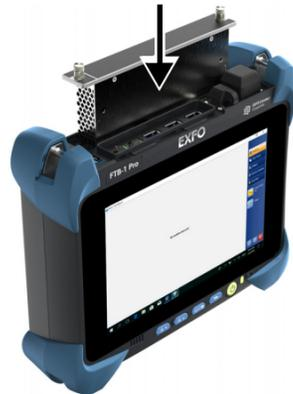
**3** Gire los dos tornillos de retención en sentido horario para fijar el módulo en su lugar. La placa frontal debe estar alineada con el panel frontal de la unidad.
