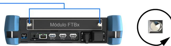
**3** Sujete el módulo por los lados o por los tornillos de retención (NO por los conectores) y tire de él.
