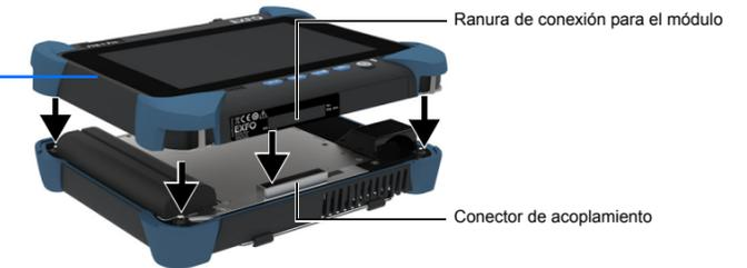
**3** Mientras sujeta el panel anterior y el módulo, manteniéndolos juntos con firmeza, voltee la unidad y colóquela de tal forma que su panel anterior descanse sobre una superficie plana, como la de una mesa.
