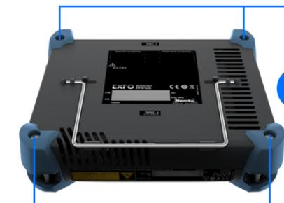
**4** Con un destornillador plano, gire los tornillos en el sentido de las agujas del reloj hasta que estén fijos.
