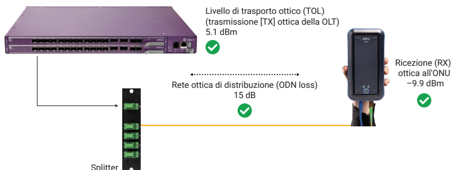
Figura 1. Letture della potenza ottica
