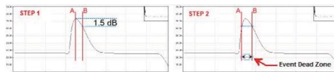
图4: 事件盲区测量方法
