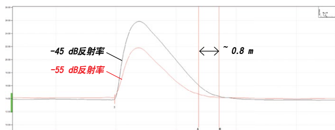
图8: 反射脉冲传输的最长距离
