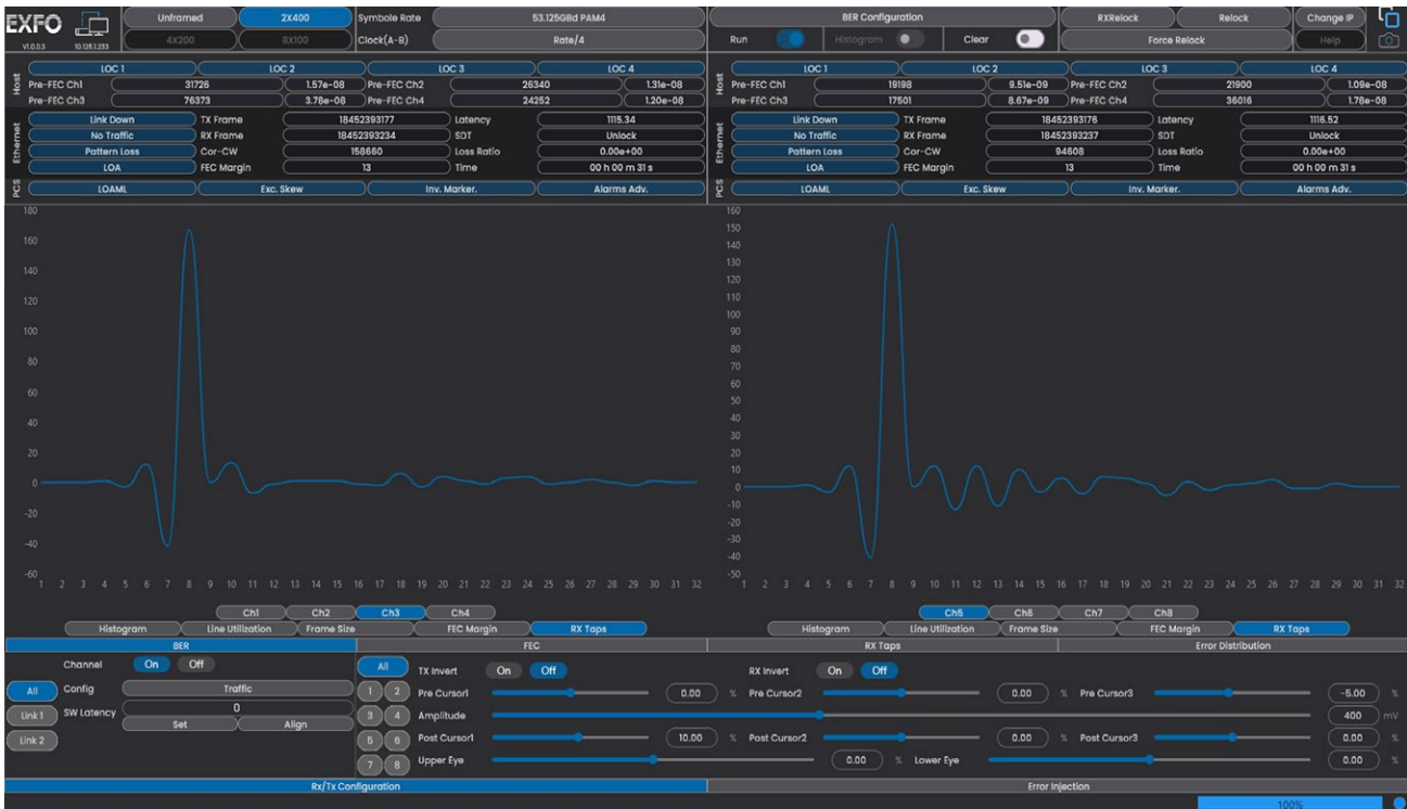
图3.检测ISI和远端反射。
