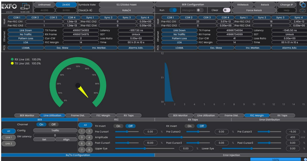
图4.测试前后的FEC误码率、符号误差分布和FEC余量。
