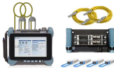
Optimierung der Transceiver-Validierungszeit durch bis zu 4xQSFP28, 4xSFP28 und 2 AOC-Kabel
