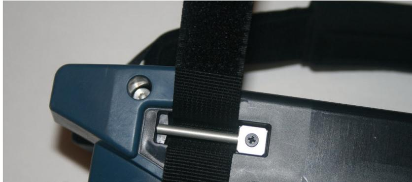
**Note:** *Si la cabeza del tornillo sobresale de la barra de metal, probablemente significa que la varilla fue colocada boca abajo. En este caso, basta con quitar el tornillo, dar la vuelta a la barra y volver a colocar el tornillo.*
