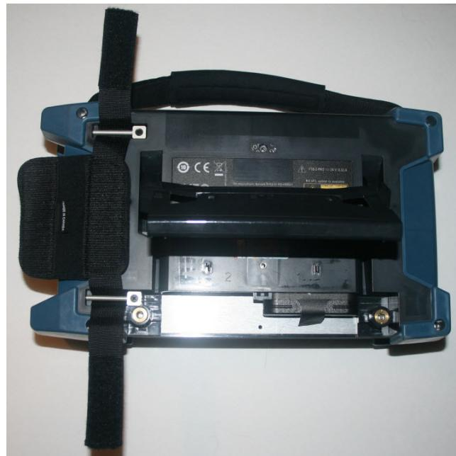
**7.** 用 1 号十字螺丝刀逆时针拧松金属杆的固定螺丝。
