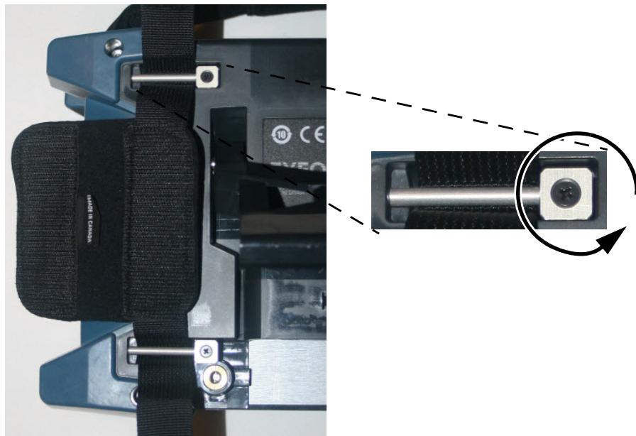
**8.** 拆下两颗螺丝，然后拆下两根金属杆（如有必要，可轻轻向上拉手提带两端）。
