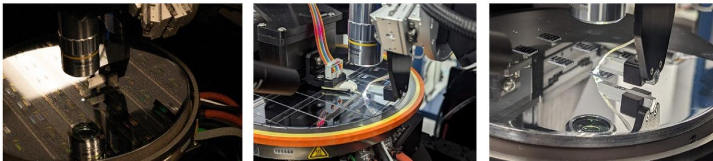
図3.OPAL-ECステーション1台で、ウェハからストレッチテープ上のシングル化ダイ、プレートアダプター上の複数のデポパージダイまで、プロセスチェーンにわたって同じ回路を再テスト。ここでは、光表面結合とDCプローブを使用。
